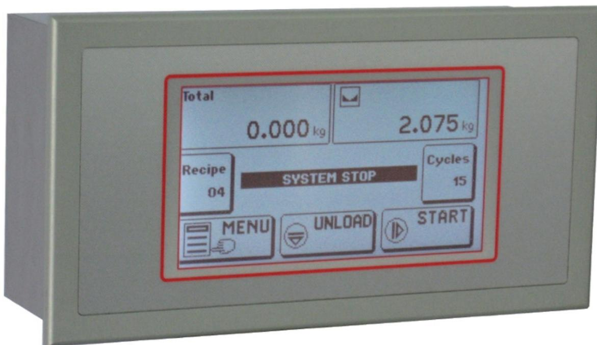
L'indicatore di peso WIN TS dispone di un display LCD 5.2" grafico, touch screen, monocromatico ad alto contrasto. Gestione 2 canali per celle di carico, e ingresso encoder incrementale, doppia uscita analogica e ingresso analogico supplementare. 6 output e 6 input integrati, espandibili con moduli esterni.
